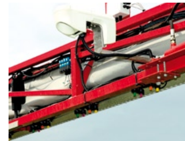
Op de spuitboom van de SensiSpray zijn zeven GreenSeekers gemonteerd. Voor elke sectie een.
