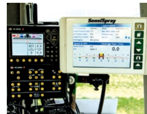
De SensiSpray-computer rekent de gegevens van de sensoren om naar een dosering. De computer is gekoppeld aan de Hardi-spuitcomputer.
