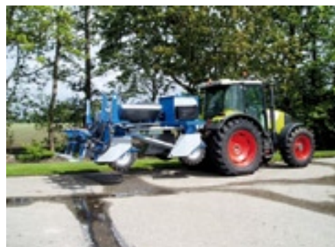
▲ Macon kan voor transport van de selectiewagen een speciaal ontworpen bok leveren. Met deze bok achter de trekker kun je de wagen op een verantwoorde manier transporteren over de openbare weg.
