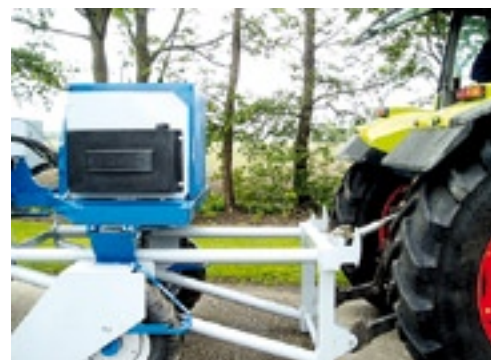
▲ Macon kan voor transport van de selectiewagen een speciaal ontworpen bok leveren. Met deze bok achter de trekker kun je de wagen op een verantwoorde manier transporteren over de openbare weg.
