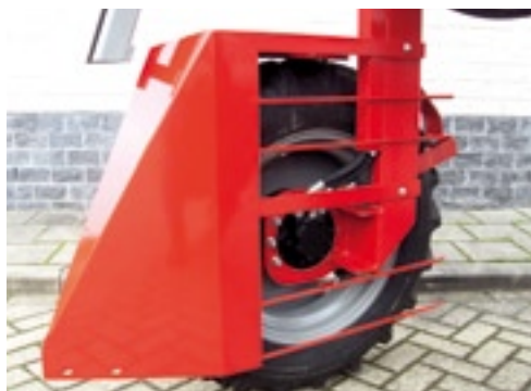
▲ Met halfopen wielkappen zijn niet alleen de wielmotoren beter bereikbaar, maar kun je het geheel onder de kap eenvoudiger reinigen.
