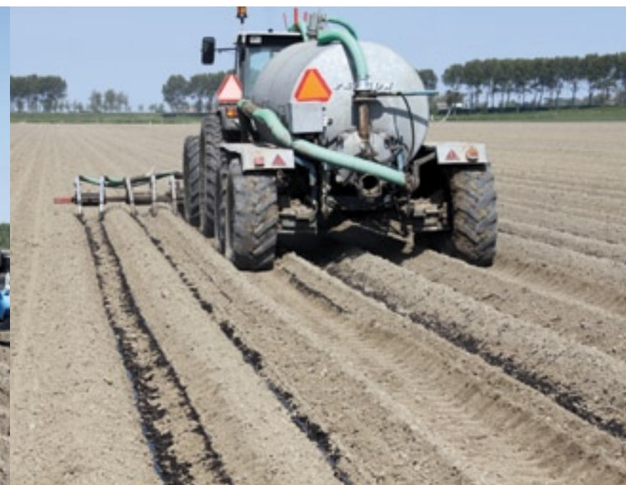
▲ Akkerbouwbedrijf Maatschap De Schipper ontwikkelde zelf een systeem. De voorop gemonteerde injecteur geeft een goed overzicht. Het resultaat tijdens de demonstratie viel helaas tegen.
