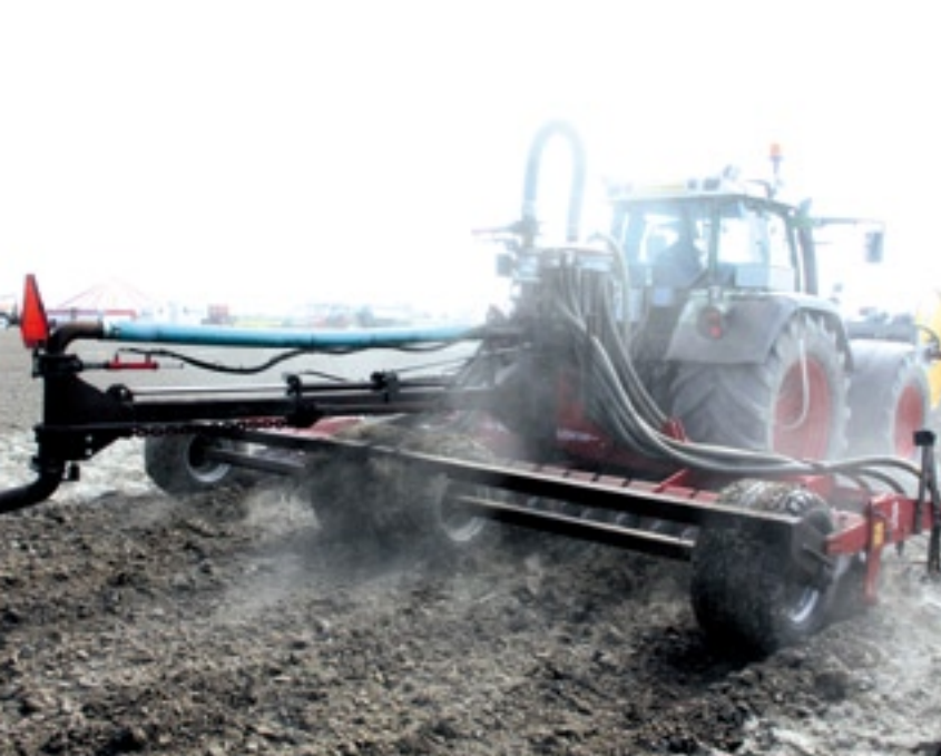
▲ Mesthandel A. Bogerman ontwikkelde samen met fabrikant Roelama de schijvenegverdeler. De machine injecteert als enige de mest voor het poten met een dubbele rij schijven.
