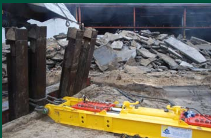
Boomgewicht trekt tonnen aan verankering scheef.
