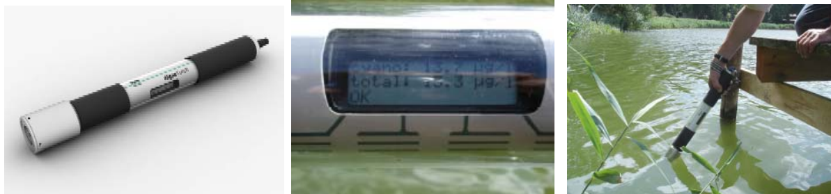
Figuur 4: de Algae Torch voor in situ fluorescentieanalyse van blauwalgen
