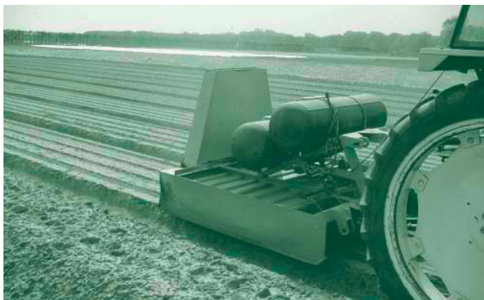
Alleen in bospeen wordt onkruid bestreden met een brander voor opkomst van het gewas
