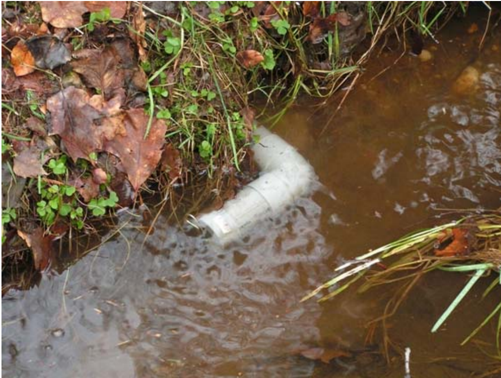
Figuur 2.1. Meetopstelling temperatuurdatalogger in beek.
