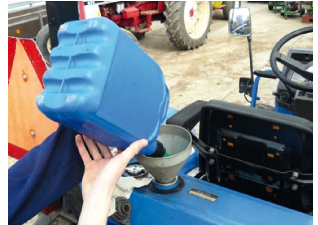
Let op als je de brandstoftank bijvult met een jerrycan. Zit er vuil of verkeerde brandstof in? Niet meer rijden en direct vervangen van de brandstof en filters kan veel onnodige kosten voorkomen.
