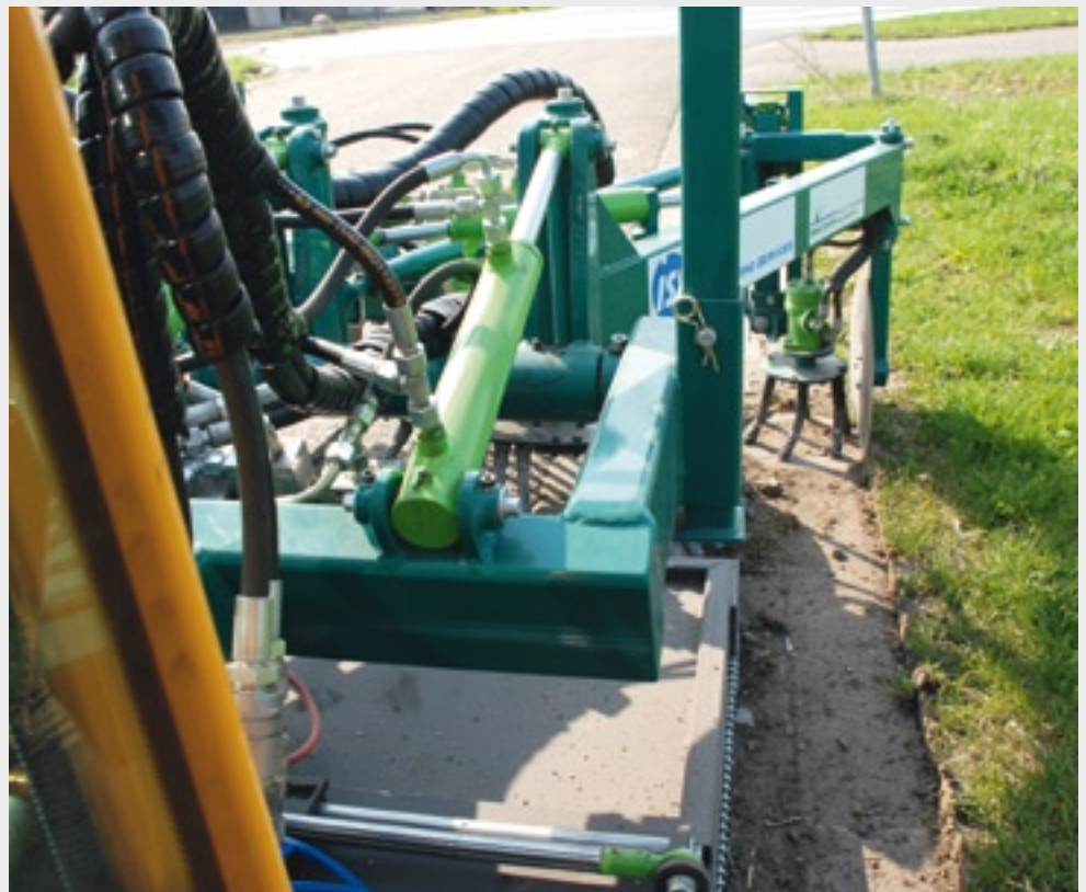
De kantensnijder zit zo'n twee meter voor het voertuig. Tijdens het werk hoeft je hier haast niet op te letten omdat hij vrij kan bewegen door een parallelogramarm.
