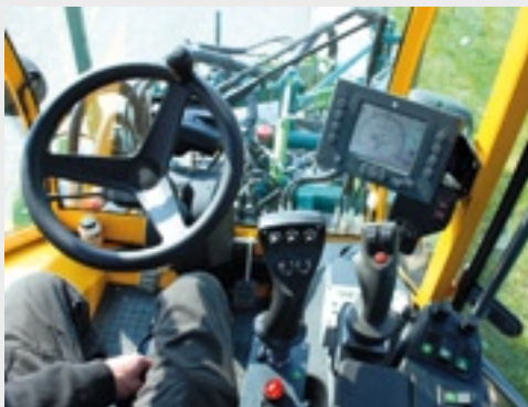
Bediening gaat via twee joysticks, een paar drukknoppen en een kastje voor de brander.
