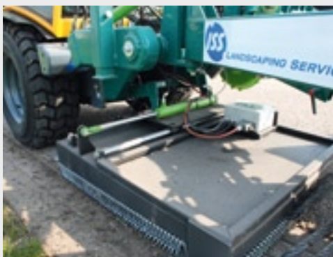
De brander met sideshift zit in de hef, de rest zit vast aan het chassis van het voertuig.
