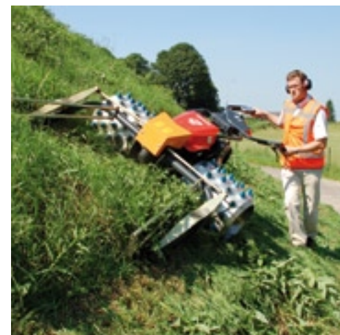
Aluminium noppenwalsen met vervangbare kunststof noppen geven veel grip en rijden comfortabel op de weg.
