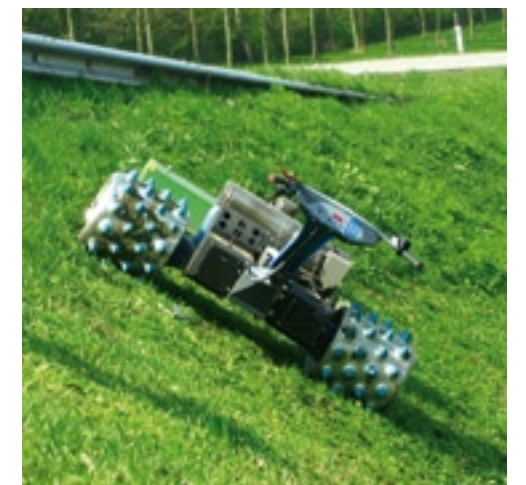
Voor erg steile hellingen kan Brielmaier een afstandsbediening leveren. Aanpassing op de machine is een on/off-schakelaar, dodemansschakelaar en ledflitslamp.
