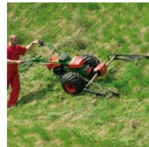
Nieuw bij Agria is een portaalmaaibalk. Doordat er geen middenaandrijving is, stroopt het minder snel.
