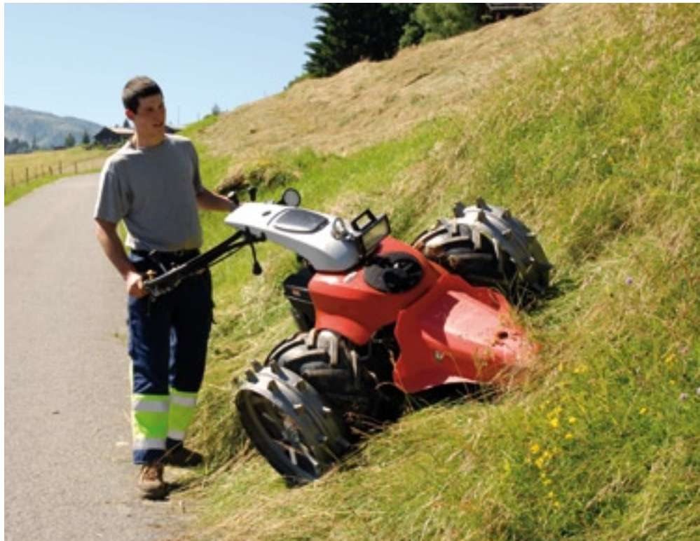
Bij deze Aebi CC56 zijn de buitenste dubbelluchtwielen vervangen door ijzeren puntwielen voor extra grip.
