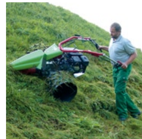
Op erg steile taluds is het plezierig dat de machine, naast veel grip door ijzeren puntwielen, ook soepel te bedienen is via een beweegbare duwboom.
