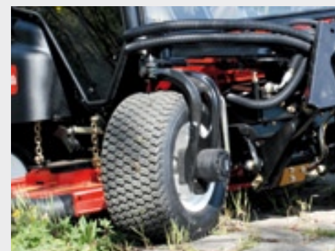
Alle vier de wielen kunnen door de speciale ophanging een grote stuuruitslag maken.
