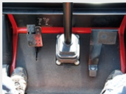
De bediening is eenvoudig: een rempedaal en een rijpedaal.
