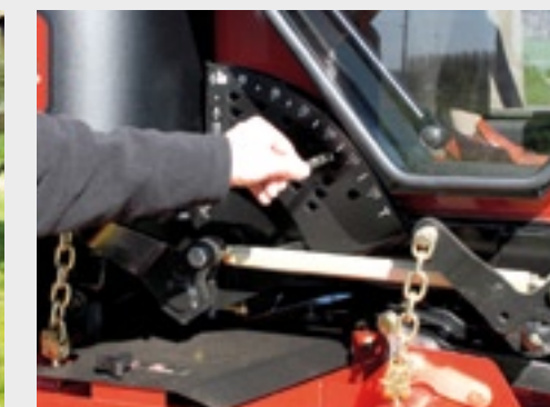
De maaihogte instellen gaat eenvoudig via een pen.
