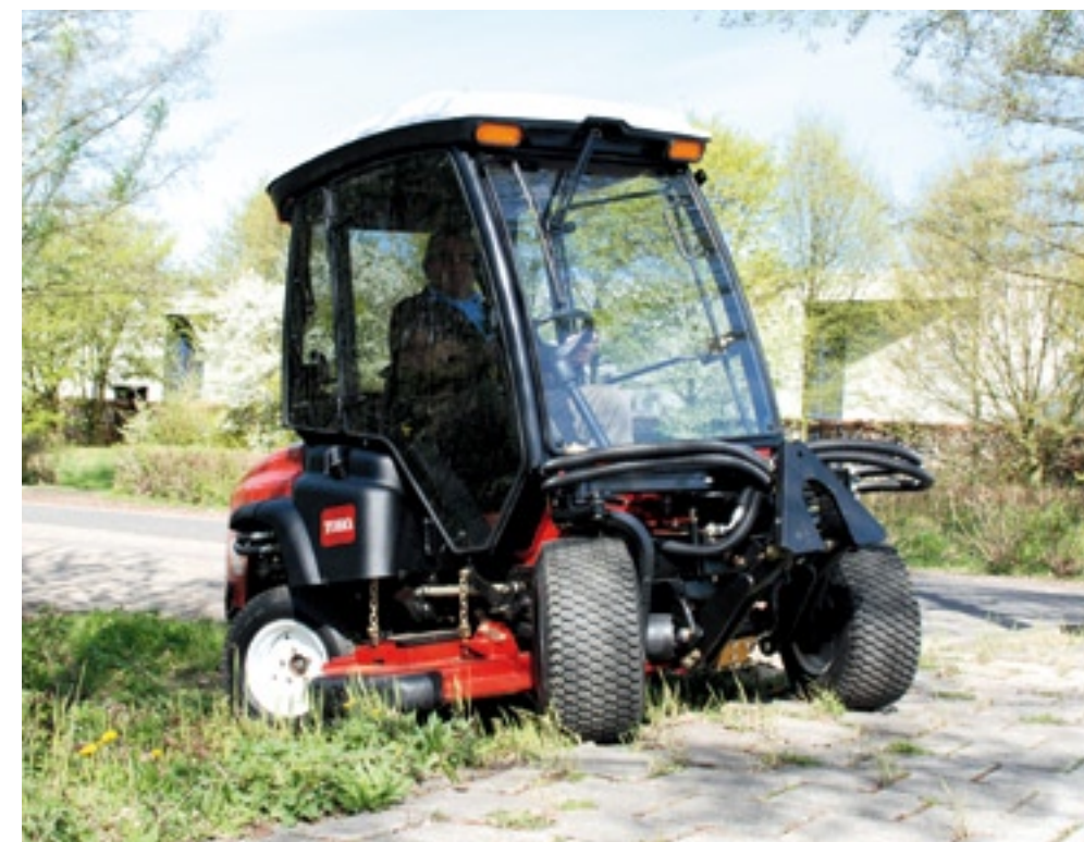
Door de vier grote wielen is de bodemvrijheid hoog en zijn stoepranden geen probleem.
