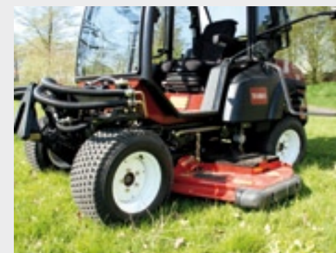
Het maaidek hangt aan kettingen en heft hydraulisch.
