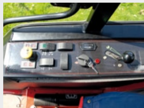
De schakelaar met groen lampje is voor de twee- of vierwielbesturing.
