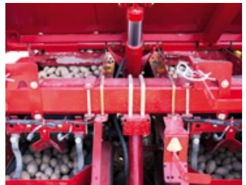
▲ Het pootgoed gaat vanaf de bunker via de pootbanden naar de snaren.
