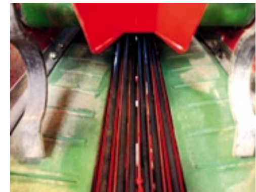
▲ Wanneer je van pootgoedmaat verandert, dien je ook de snarengoten (rechts) aan te passen. Dat voorkomt dubbelaars. Met een hendel aan rechterkant van de machine (links) pas je de breedte van de trog aan.
