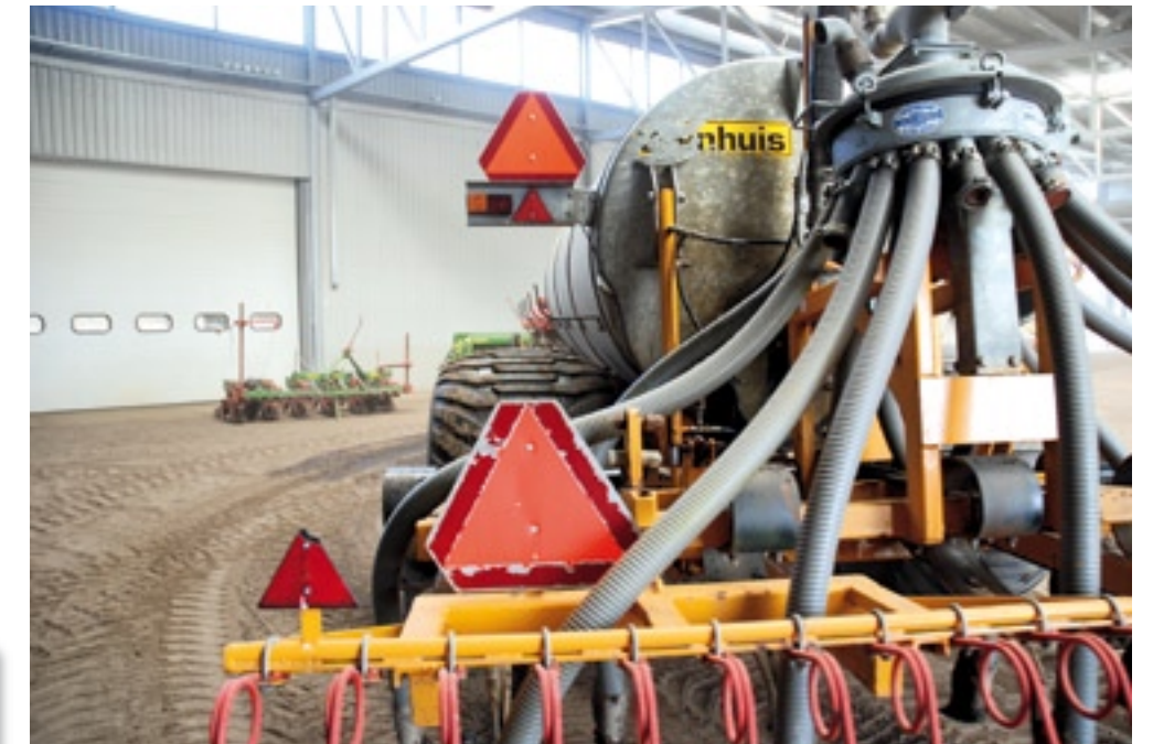
▲ Achterop een machine moet een afgeknotte driehoek zichtbaar zijn. Maar bij deze machine ontbreken de borden van de breedtemarkering.
