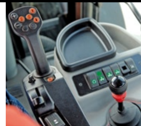
▲ Met de vaste hendel voorop de rechterarmleuning bedien je de traploze ZF-versnellingsbak. Voor die hendel vind je de rijhendel.
