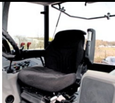
▲ De cabine oogt zo eenvoudig als we van Oost-Europese trekkers gewend zijn. Er is een luchtgeveerde Grammer-stoel en een bijrijderszit.
