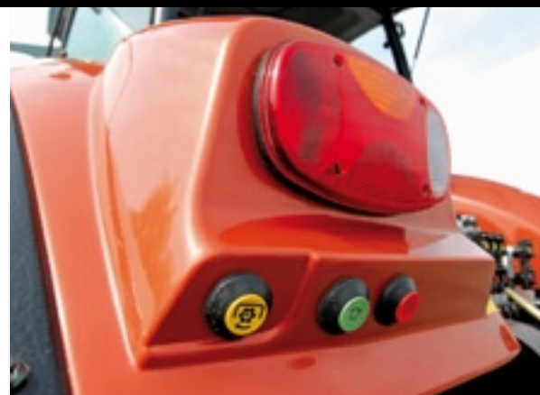
▲ De 1.000-toerige aftakas en de hefinrichting, beide van Bosch, bedien je met knoppen op het spatbord.
