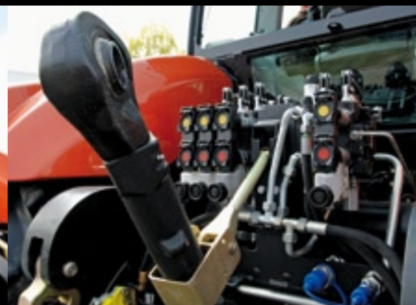
▲ De Terrion ATM 7360 is voorzien van een load-sensingsysteem dat minimaal 110 liter olie per minuut levert.
