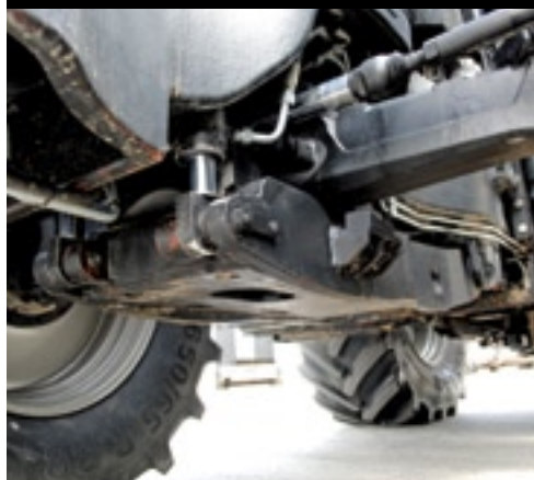
▲ De Dana vooras is voorzien van een door Terrion zelf ontworpen voorasvering.
