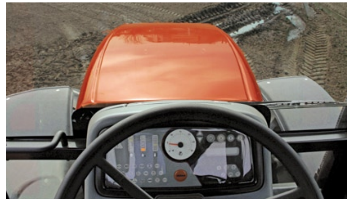
▲ Het prototype van de Terrion ATM7360 heeft nog een eenvoudig dashboard. In de definitieve versie moet een lcd-scherm veel extra informatie geven. De grote motorkap ontnemt je het zicht op de fronthef.
