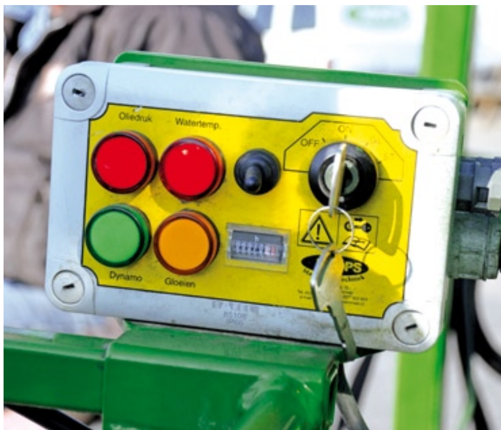
▲ Op de bedieningskast kun je de urenstand aflezen, maar ook is te zien wanneer je na het gloeien van de motor kunt starten. De activiteit van de dynamo is ook te controleren.
