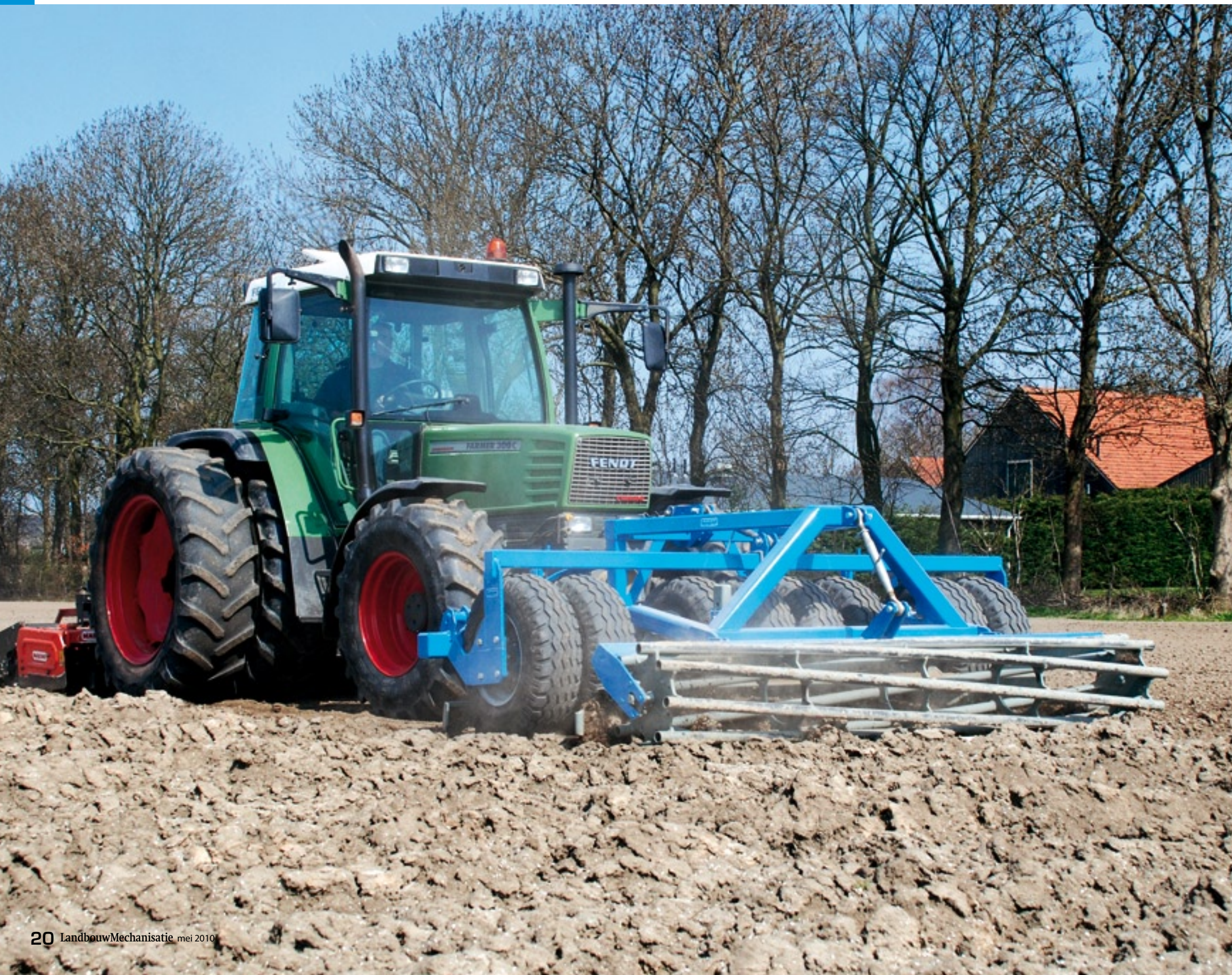
▲ Een speciale egalisatieplaat met gelaste V-vormen en pennen legt de grond vlak weg.
