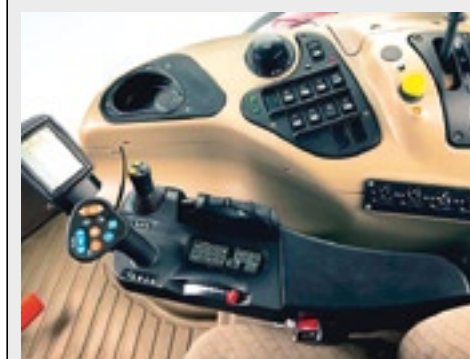
▲ De joystick voor de hydrauliek is een optie. Onze Puma had mechanische ventielen.
