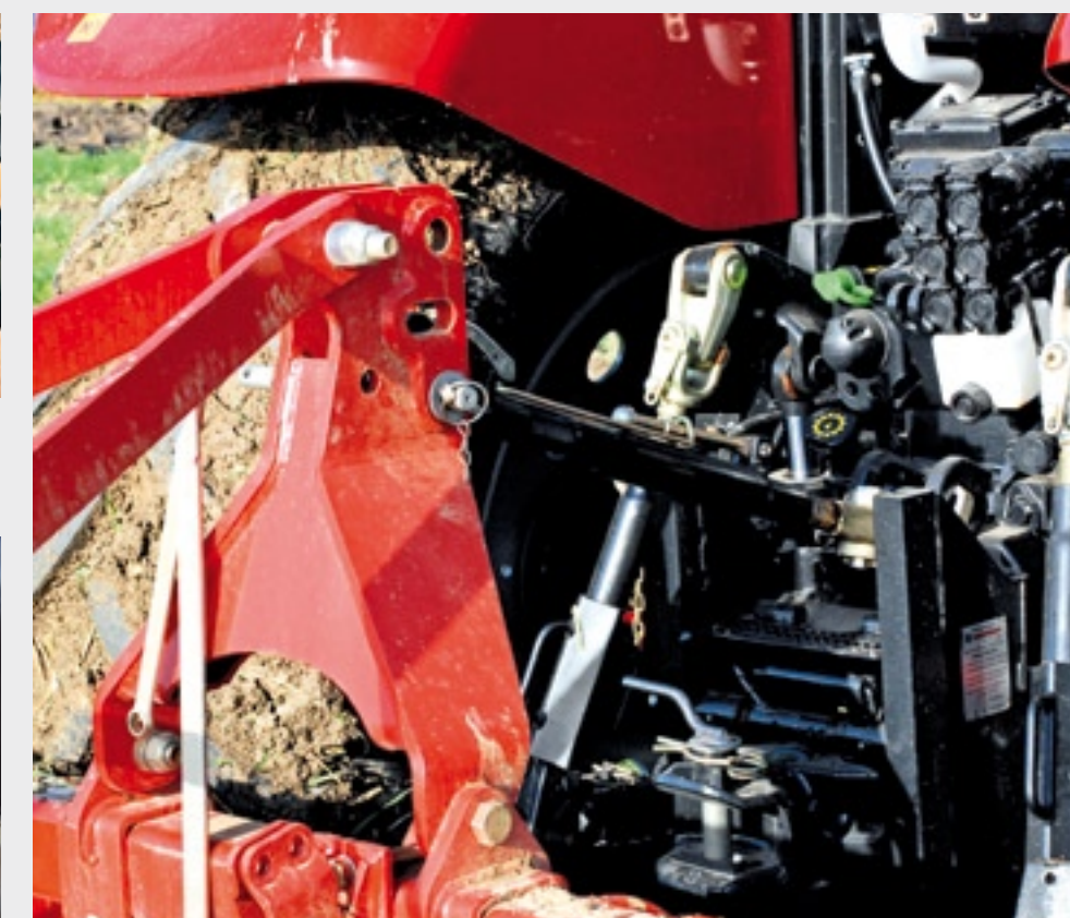
▲ De hef heeft meer dan voldoende kracht en ook de hydrauliek mag zich qua literopbrengst laten zien. De mechanische ventielen zijn op de achterbrug instelbaar, de elektrische ventielen vanuit de cabine.
