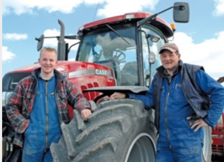
▲ Arjan (links) en Koos Bos met de Puma op de XeoBib van Michelin. Bij Bos durven ze op dit rubber tot 0,4 bar te gaan. De band vraagt een aangepaste velg.
