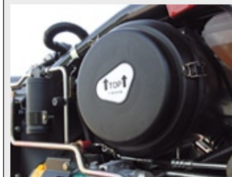
▲ Het luchtfilter is op zich goed bereikbaar, maar je moet eerst tussen voorwiel en tank door.
