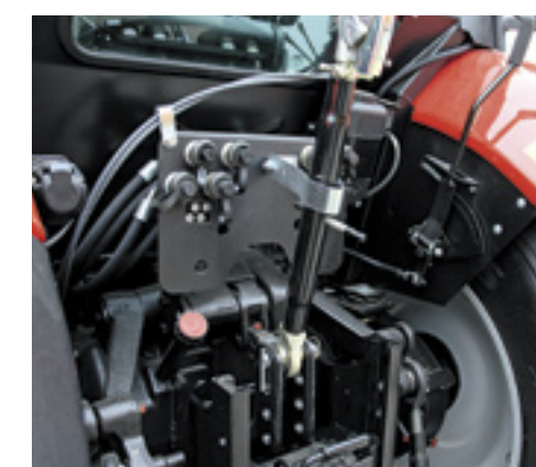
De hef van de de 105.41 heeft een mechanische regeling via de topstang. Ook de buiten bediening is mechanisch.
