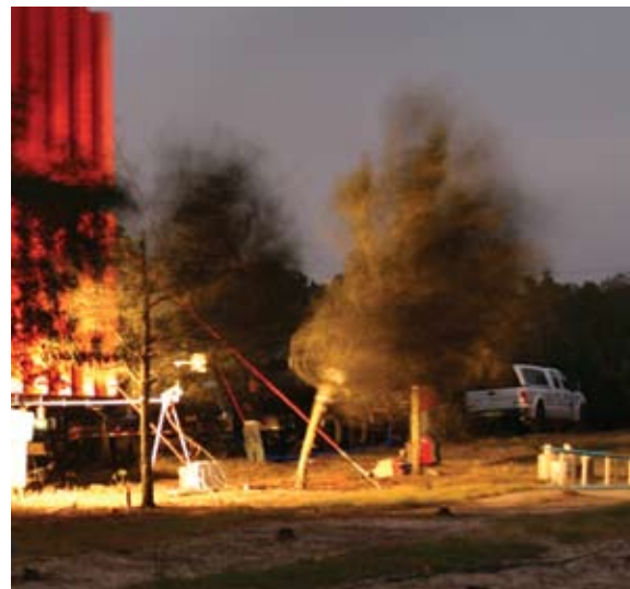
4. Boom onder stormbelasting met meetinstrumenten op de stam.
