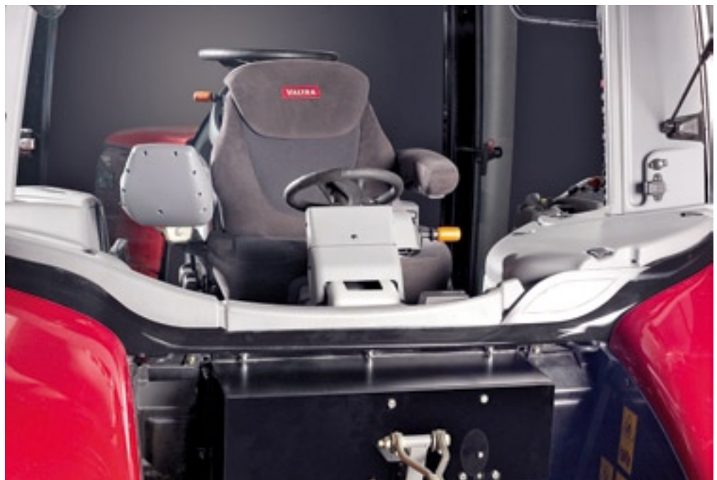
▲ Valtra bouwt een nieuwe terugrij-inrichting. Het stuurwiel is niet met stangen met de wielen verbonden, maar via elektronica en een Canbus-kabel. Dat neemt minder plaats in.
