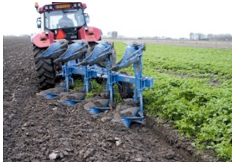
▲ De risters hebben een goede kerende werking, de sneden sluiten netjes aan.
