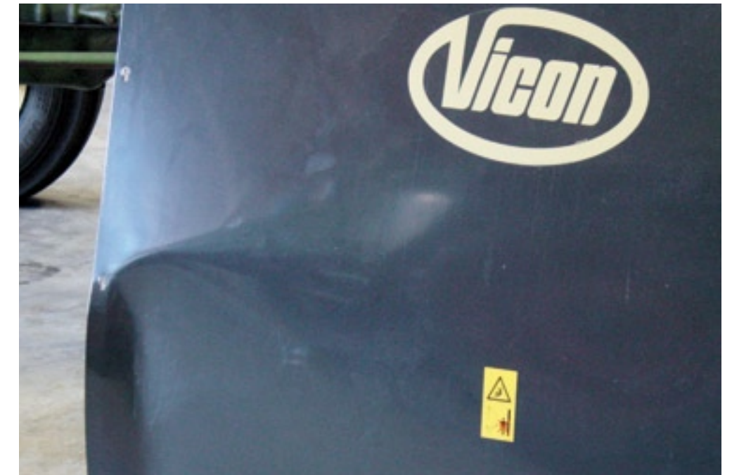
▲ Een schade van deze omvang van de losklep van de Vicon oprolpers is goed te behandelen.
