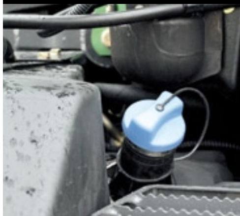
▲ Naast de 505 liter brandstoftank is nog een blauwe dop te vinden. Daarachter schuilt de 32 liter grote AdBlue-tank.
