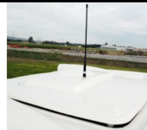
▲ De ontvanger van zowel gps, Glonass als toekomstige Galileo satellieten is weggewerkt in het dak van de X5-cabine.
