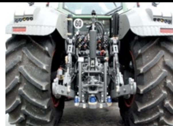
▲ De hef van de 800 Vario trekkers tillen 11.110 daN. Dat is bijna 2.000 daN meer dan de trekkers uit de oude 800 Vario serie.
