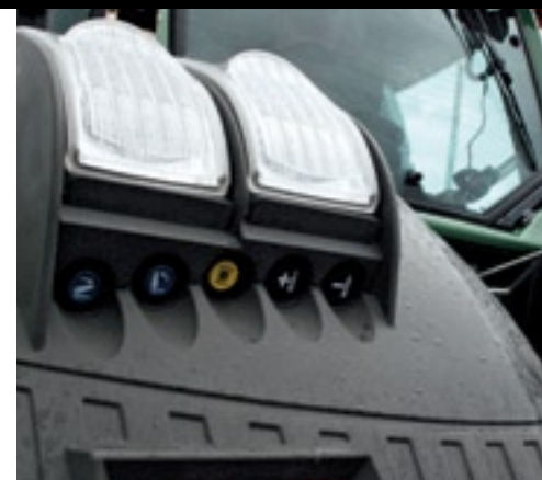
▲ De hef, de aftakas en de hydraulische ventielen zijn met knoppen op het achterspatbord te bedienen. De witte ledlampen zijn een optie.
