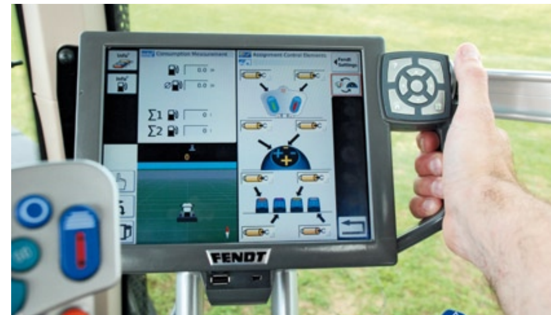
▲ De Fendt 824 Vario Profi Plus is standaard uitgerust met de nieuwe 10,4 inch (26,4 cm) Varioterminal met aanraakscherm. Daarmee bedien je de hele trekker en werktuigen die zijn aangesloten op de isobus.
