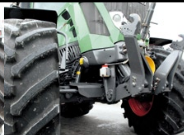
▲ De vooras is voorzien van Fendt Stability Control. Het houdt de trekker stabiel bij rijsnelheden boven 20 km/h.
