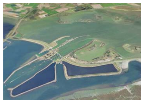
De Krammersluizen scheiden zoet- en zoutwater en vormen een obstakel voor de scheepvaart. Blauwwalgen kleuren het zoete water (rechts op foto) groen.
