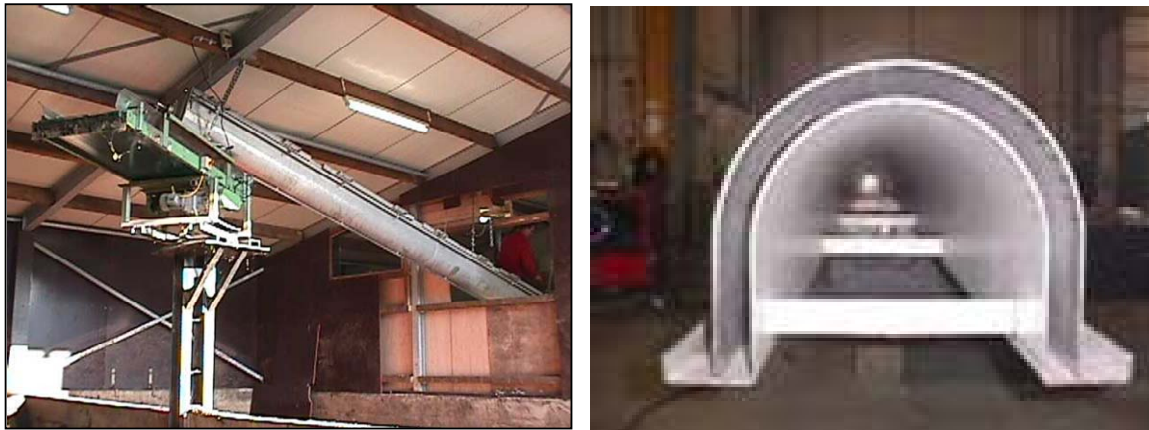
Fig. 6 Thermische vijzel (Foto Willems Waste Technology)
