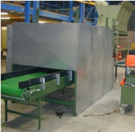
Fig. 5 Prototype voor het di-electrisch ontsmetten van substraat (foto Potveer).
