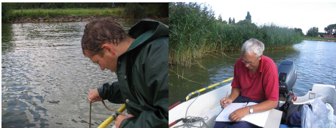
Figuur 2.6. Foto links: Meten van zichtdiepte met een Secchischijf Foto rechts: Noteren van de vangst op turflijsten
