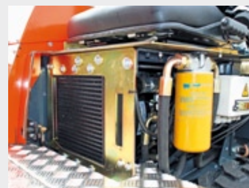
De oliekoeler en zekeringen zitten onder de stoel. De beschermkap verwijder je met twee bouten.
