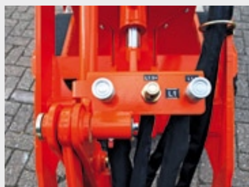
De derde functie is voorzien van een arretering. De koppelingen kunnen scharnieren om een pen.
