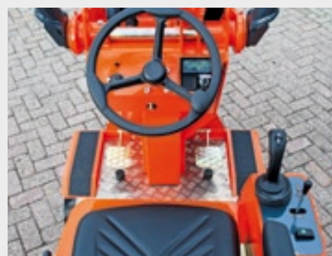
De minishovel heeft een eenvoudig dashboard met een digitaal display. Een tankmeter ontbreekt.
