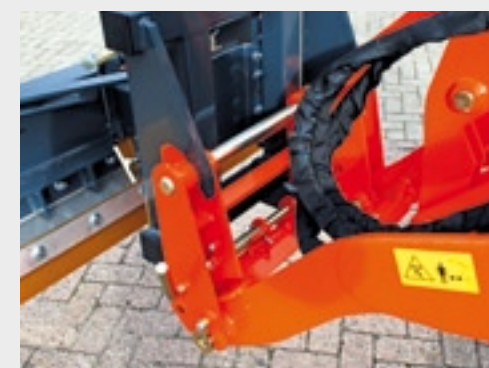
Het aankoppelframe vergrendelt zichzelf na het aanpakken van het aanbouwdeel.
