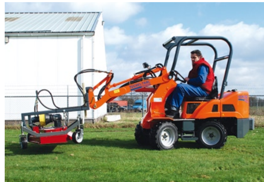
De vierwielbesturing moet de minishovel wendbaar maken en zorgen dat hij stabiel blijft. De vierwielbesturing zorgt ervoor dat het zwaartepunt van de machine volledig uitgestuurd gelijk blijft.
