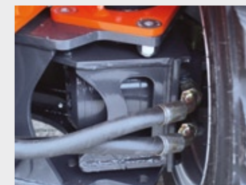
De minishovel heeft vierwielbesturing en elk wiel is voorzien van een rijmotor.
