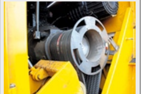
Twaalf V-snaren drijven een centrale as aan die de 5 ton wegende frees aandrijft.
