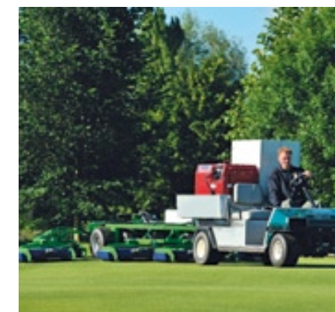
Om de 4 meter brede uv-machine van genoeg stroom te voorzien, moet er een grote generator en een voorschakelkast op. Hierdoor is de machine te zwaar.
