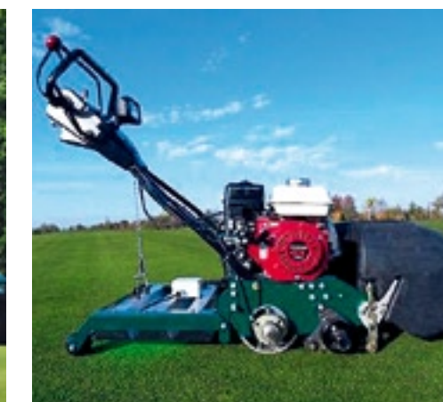
Bij de nieuwe CGC 0.6, binnenkort als opbouw-pakket leverbaar, zit de lichtbak met uv-licht aan een handgreenmaaier. Zo kun je tijdens het maaien tevens schimmels bestrijden.
