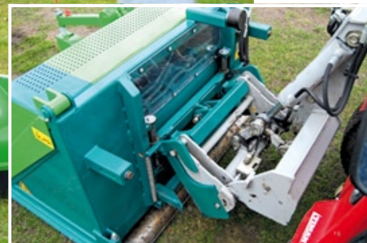
Door de speciale aankoppeling kan de Poop scoop in werkstand vrij pendelen.
