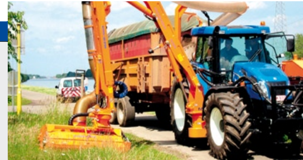
De Götde arm heeft als zwenksysteem twee cilinders die een ketting trekken.
