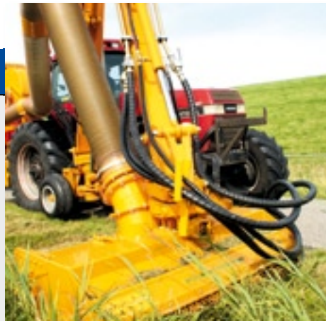
Nieuw bij de Bos maaïarm is een 240 graden zwenksysteem.
