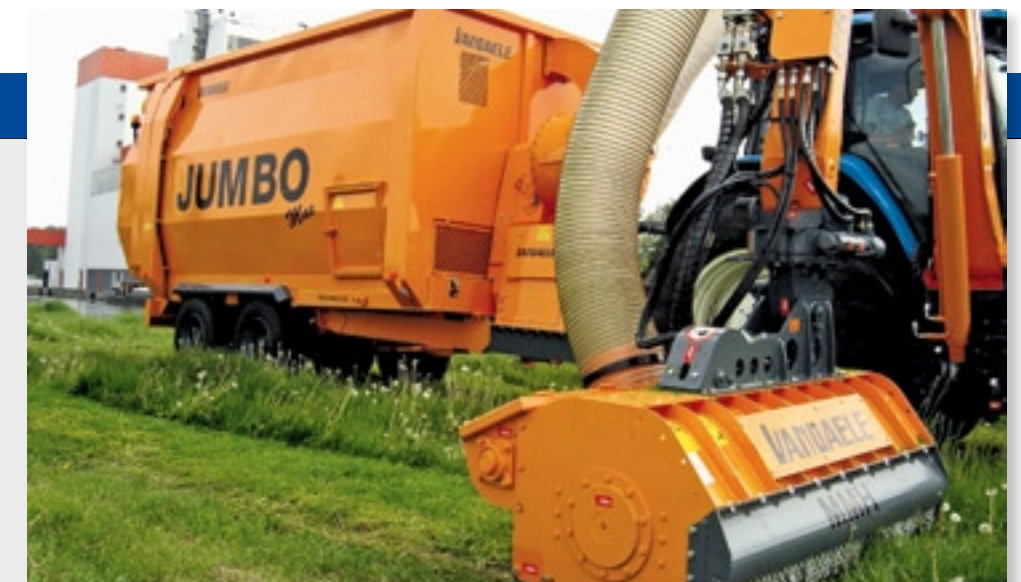
Vandaele maakt ook een eigen zuigwagen waarbij de maaïarm op de dissel kan. Met de maaïarm voor middenaanbouw heb je wel meer reikwijdte.
