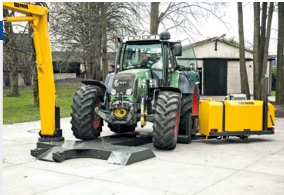
De Hemos hydraulische giekeraanbouw Orca is binnen 10 minuten van de trekker af en aan te koppelen. Het hele chassis is slechts met twee pennen aan de trekker bij de vooras vergrendeld.
