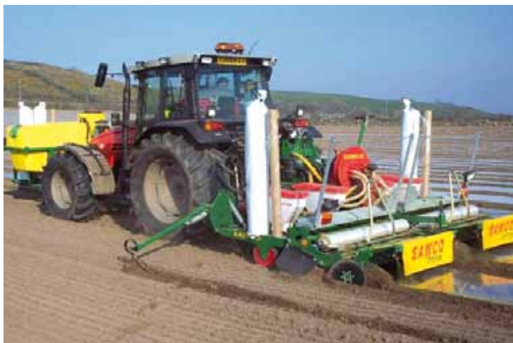
◀ Bij het zaaien onder folie vindt alles in één werkgang plaats. Dus zaaien, het toedienen van kunstmest en het spuiten van een bodemherbicide.
