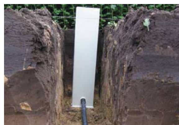
Van een lysimeter blijft bovengronds alleen de plastic koker zichtbaar waaruit het drainwater wordt gepompt. De bovenrand van de lysimeter bleef aanvankelijk onder het maaiveld. Dat gaat veranderen.
