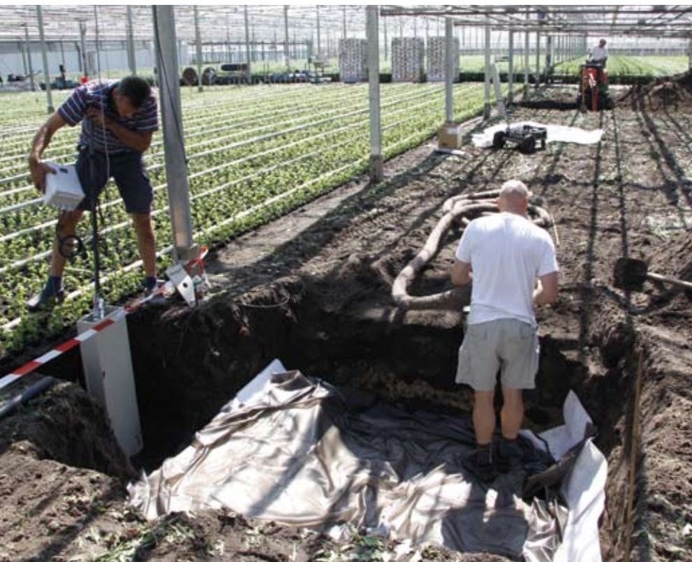
Van een lysimeter blijft bovengronds alleen de plastic koker zichtbaar waaruit het drainwater wordt gepompt. De bovenrand van de lysimeter bleef aanvankelijk onder het maaiveld. Dat gaat veranderen.
