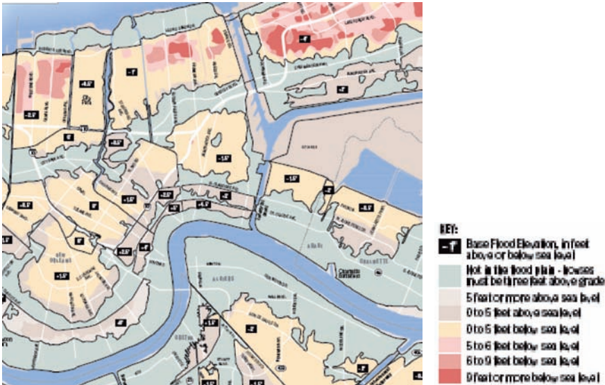
Figuur 64 FEMA kaart voor New Orleans van 'base flood elevation levels' aangegeven in 'foot' boven maaiveld (1 foot ≈ 0,3 m). Voorgeschreven wordt om altijd minimaal 1 m (3 feet) boven maaiveld te bouwen.
