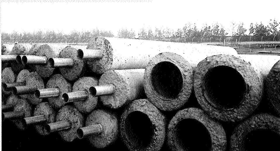
Links de penoplanger, rechts de busoplanger
