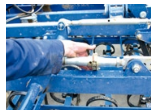
Het tandenrek is op deze foto is mechanisch in hoogte verstelbaar. Dit doe je middels een ratel.
