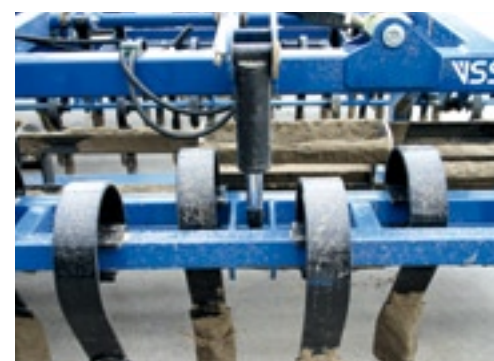
Met sleepbeitels trek je de grond al grotendeels vlak. Waverijn kan deze hydraulisch regelen.
