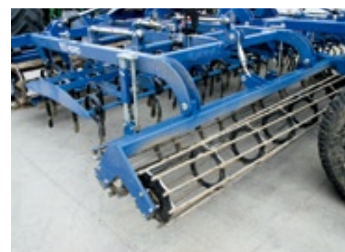
De voorste verkruiemrol gooit kluiten terug in de machine zodat ze fijnge maakt worden.
