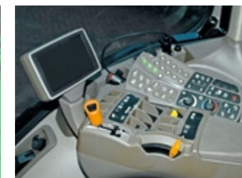
▲ De bediening is gelijk aan die van de wielversie 8R. In oranje (links) het pookje van de cvt.
