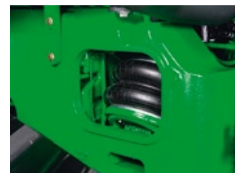
▲ De dwarsbalk die de voorzijde van de rupsen verbindt, wordt gedempd met een luchtbalg.
