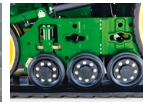
▲ De spoorbreedte is nu via bouten te verstellen zonder dat de spanning van de rups hoeft.
