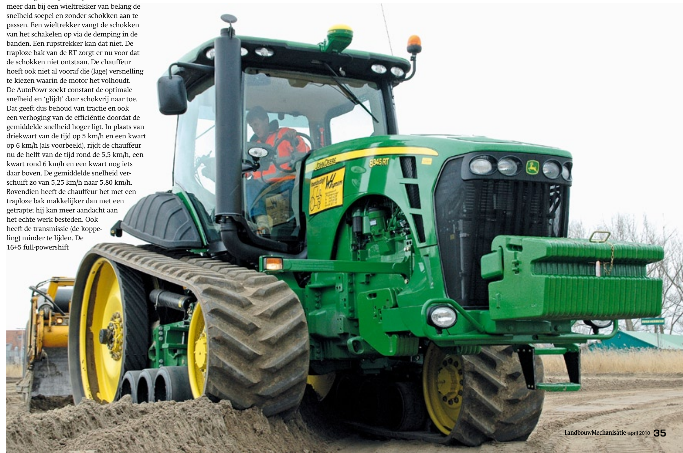
▲ De dwarsbalk die de voorzijde van de rupsen verbindt, wordt gedempd met een luchtbalg.
