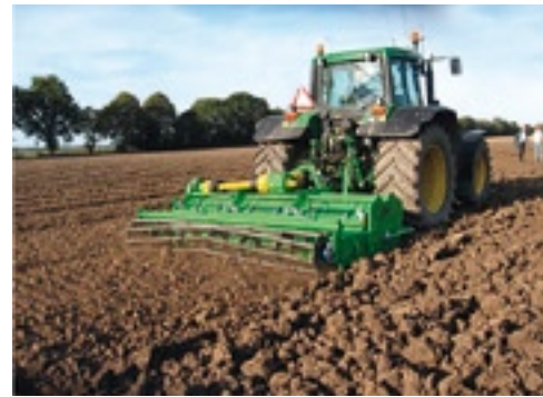
▲ De G-force van AVR heeft, om torsie op te vangen, een aftakas tussen beide tandwielkasten.
