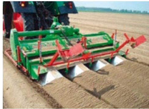
▲ Om rijpaden snel aan te leggen, kun je de rijpadruimers van Baselier hydraulisch bedienen.
