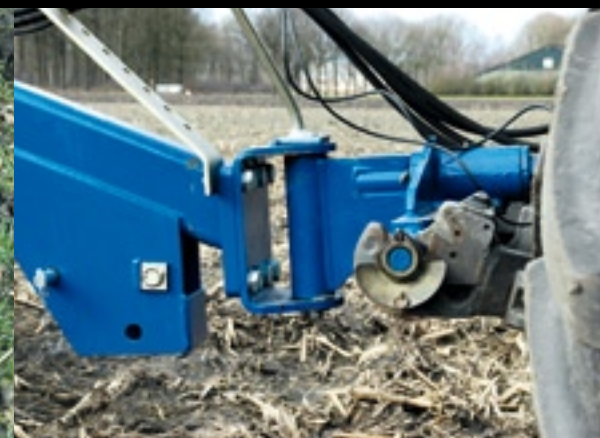
▲ De hoogte van de aanspanning bepaalt de werking: de beide voorste rollen moeten precies vlak lopen met de achterste.
