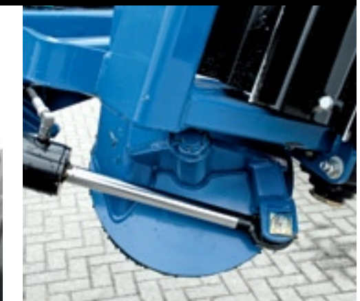
▲ Het schamierpunt stuurt de buitenste rollen tijdens het opklappen wat naar binnen, waardoor de transportbreedte binnen de perken blijft.
