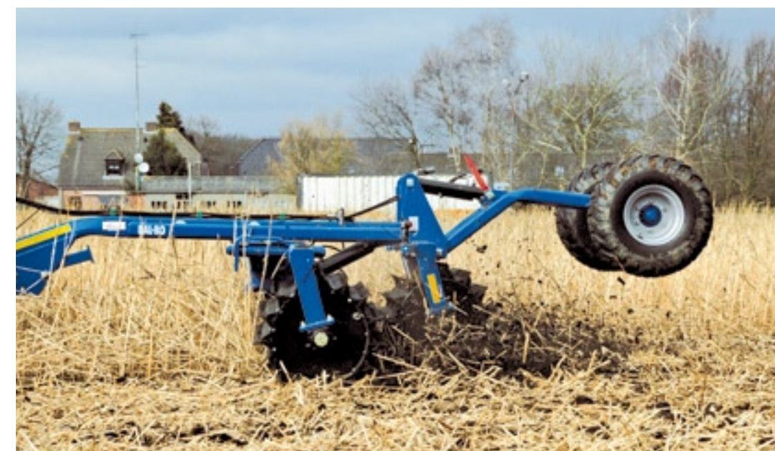
▲ Dal-Bo geeft voor de MaxiCut een werksnelheid aan tussen 18 en 25 km/h. De messen werpen dan na het snijden de gewasresten en de toplaag van de grond wat omhoog. Dat geeft een goede menging.
