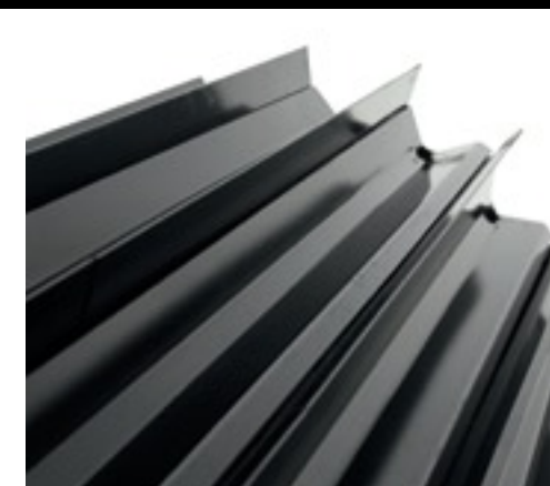
▲ De messen zijn 2 meter breed en 10 cm hoog. Ze staan aan de voet 13 cm uit elkaar; bovenaan is die afstand 17 cm.
