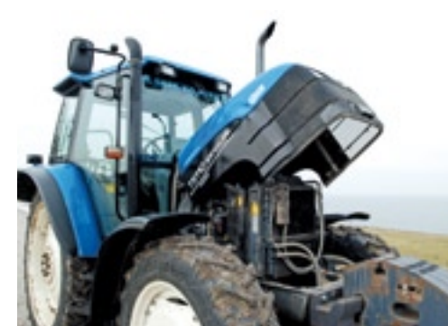
▲ Onder de motorkap, die in één stuk openklapt, ligt een viercilindermotor met een vermogen van 80,5 kW (108 pk).
