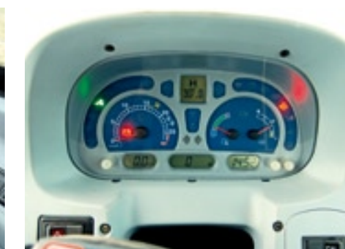
▲ Het dashboard van de T5060 is overzichtelijk met een mengsel van analoge klokken en digitale displays.
