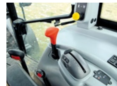
▲ De hendel voor het handgas in de cabine van de T5060 is in vergelijking met de andere hendels buiten proporties.
