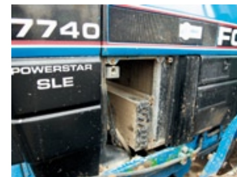
▲ Voor de radiator van de 7740 zit een brandstoftank. Dat zorgt ervoor dat de trekker snel warm kan worden.
