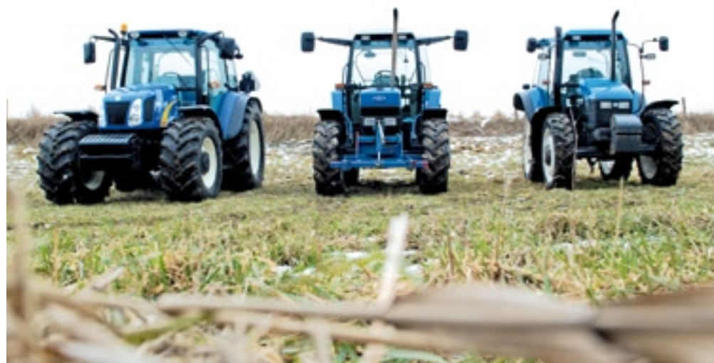
▲ Drie blauwe trekkers met een viercilindermotor van 110 pk. Een oude Ford 7740 SLE, (midden), een jonggebruikte New Holland TS110 (rechts) en een New Holland T5060 (links). Bij de laatste stroomt toch nog een beetje roodbruin bloed door de aderen.
