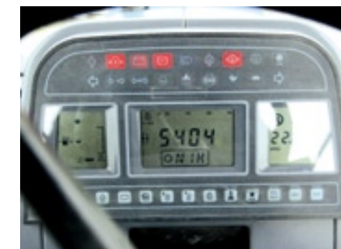
▲ De 7740 heeft een digitaal, maar wat onoverzichtelijk dashboard. Je mist de analoge toerenteller. Wel is er een prestatietester.
