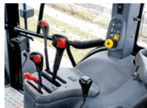
▲ De TS110 is voorzien van een soms wat stroef schakelende groepenschakeling. De aftakas kent nog geen spaarstand.
