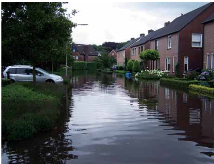
De straten staan blank na een hevige regenbui in Hoveen door een te krap gedimensioneerde riolering (foto: Ellen Tromp).
