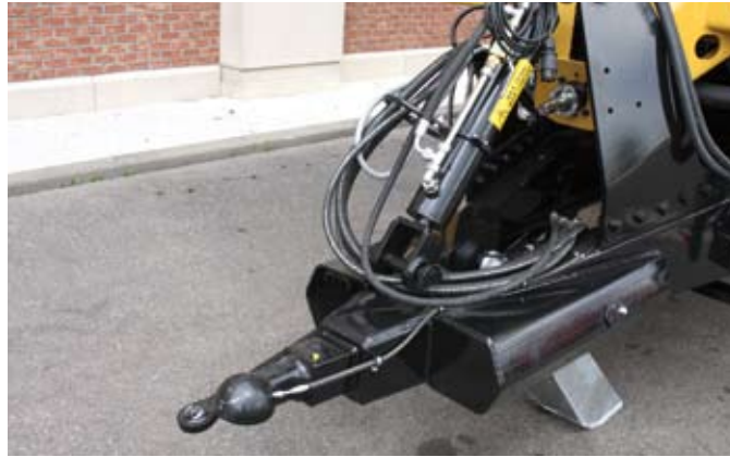
◀ De wagens zijn standaard voorzien van een Scharmüller-koppeling en een hydraulisch geveerde dissel.
