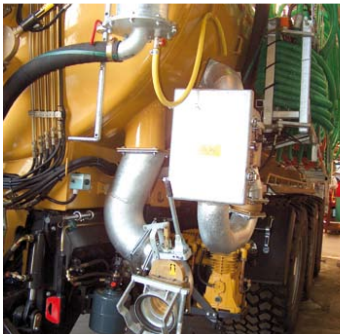
◀ Een centrifugaalpomp in combinatie met een vacuümpomp zorgt voor snel laden en lossen.
