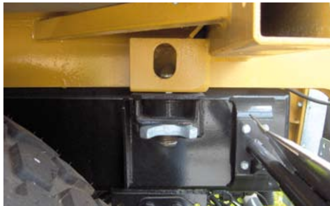
◀ Een losse constructie tussen bak en onderwagen is volgens Van Bakel noodzakelijk om voldoende beweging in het chassis te houden en scheuren te voorkomen.
