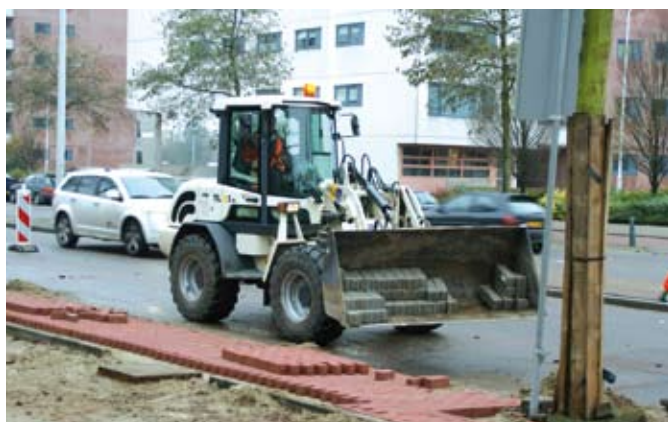
Een Deutz D 2011-viercilindermotor levert een vermogen van 44 kW (60 pk). Dat is goed voor een rijsnelheid van maximaal 36 km/u.
