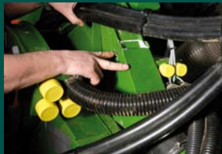
1. Mondstuk op de ventilator. Zorg dat deze goed is afgekit, anders lekt hij geheel.
