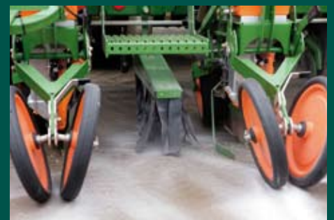
5. Helemaal onderaan zitten twee van deze uitstroomopeningen met rubberen flappen.
