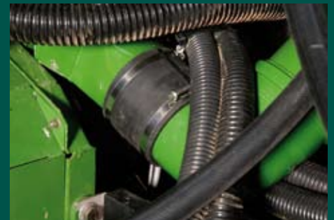
2. Na het mondstuk een flexibele rubberen mof om trillingen op te vangen.
