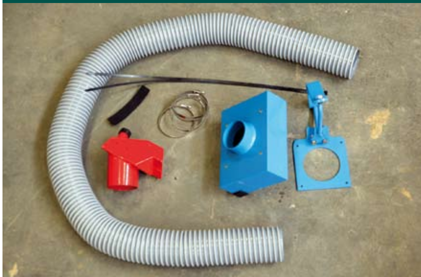
Hier een opbouwset voor de Monosem. Een handige monteur heeft die in een goed uur gemonteerd.
