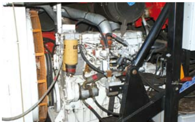
◀ De aandrijflijn is simpel: een Cat met hydropomp en een paar hydromotoren. De beveiliging heeft programma's met automatische heen- en terugdraai-intervallen.
