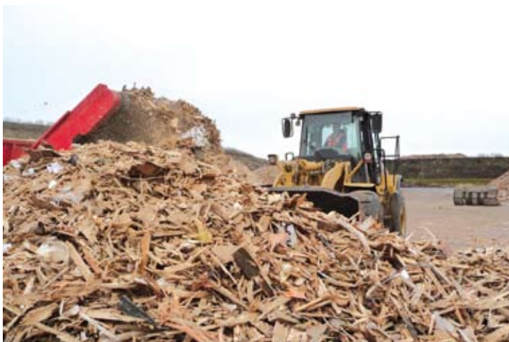
◀ De Hammel levert voor biofilters en voor verbrandingsovens een prima product. De losband was, zoals hier, wat aan de korte kant, maar is verlengd tot 4,60 meter loshoogte.
