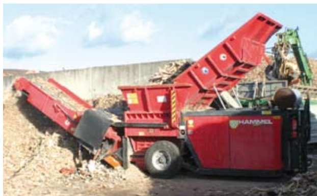
◀ De invoerbunker is hydraulisch op te klappen. De hellingshoek bepaalt de toevoer. Daarmee kun je de eindkwaliteit bespelen.
