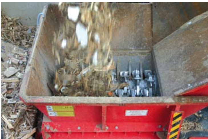
◀ De twee vaste rotors met vaste messen en haken vreten letterlijk alles en breken het materiaal middendoor. Fijn en taai hout wordt minder verkleind, dikker hout kraakt de machine probleemloos op maat.
