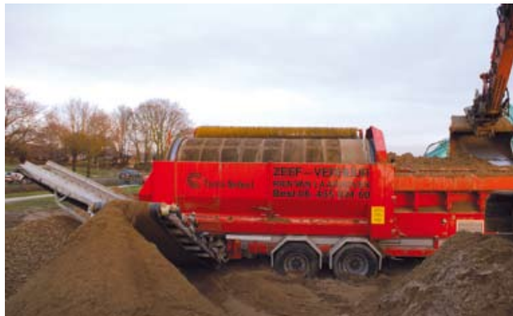
◀ Rien van Laarhoven draait met deze Terra Select T6-trommel-zeven. Deze hebben een trommel met een doorsnede van 2,20 meter en een lengte van 5,50 meter.
