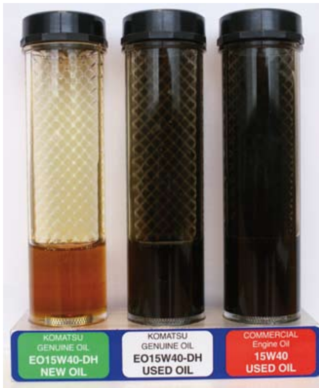
Bia heeft een eigen demonstratieset om het verschil in viscositeit van olie te laten zien. Links de ongebruikte olie ongeveer een halve minuut na het schudden. Rechts een goedkope standaard olie. Duidelijk is te zien dat deze veel minder snel uitzakt.
