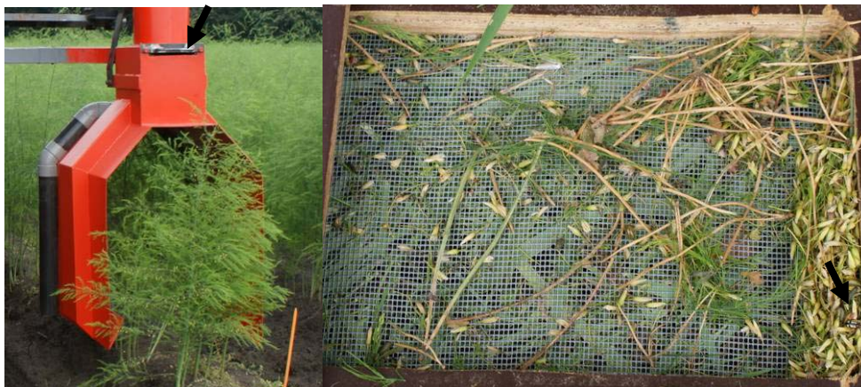
Figuur 4. Links de zuigmond met bij het pijltje de zeef, rechts de vangst op de zeef. Vlak onder de pijl zit een aspergekever.
