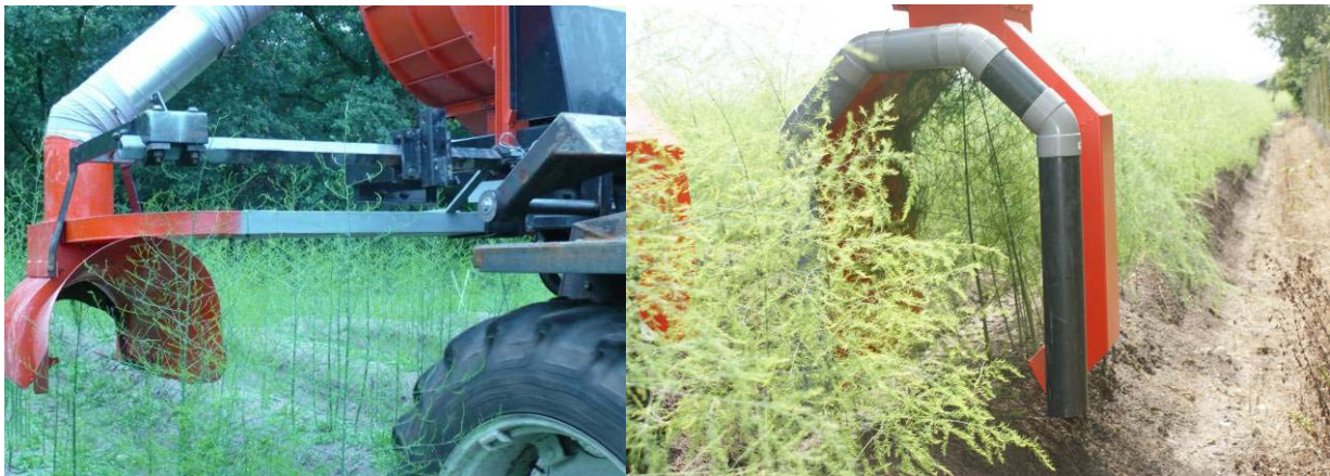
Figuur 5. De zuig- blaasmond van de "Beetle Eater" gebruikt in 2008 (links) en in 2009 (rechts).
