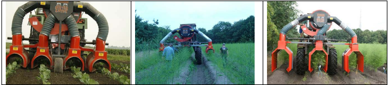
Figuur 1. De ontwikkeling van de Beetle Eater, links 2007 niet aangepast in een koolgewas, midden 2008 aangepast voor asperges, rechts 2009 verder aangepast.
