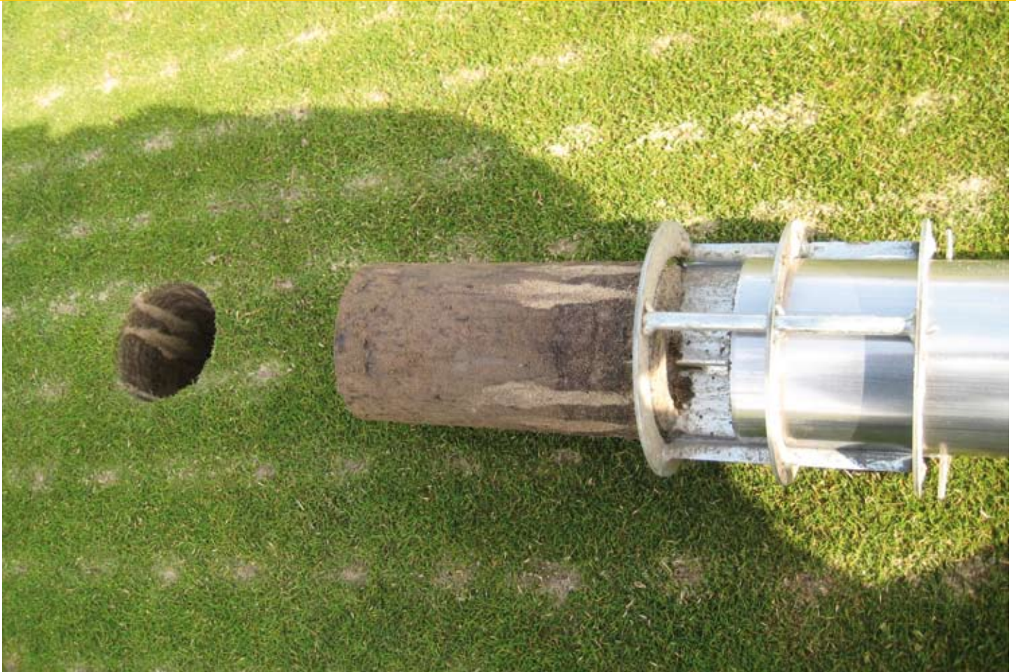
Een grondmonster met dryject sleuven/sporen
