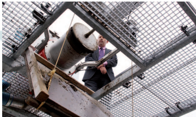
Na de druk op de startknop, kijkt Siem Jan Schenk toe hoe de dikke fractie voor het eerst door het valluik valt op de speciaal hiervoor aangelegde mestplaat van De Marke.
